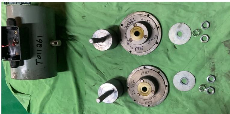
分解完成开始清洁作业（铁心清洁铁心有生锈用 600 号以上砂纸打磨）清洁完成填写作业人员时间，清洁完毕开始复归作业。
